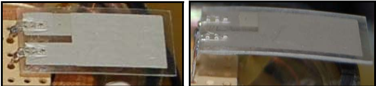
Figura 3.8. Imatge del sensor emprat, la figura de la dreta mostra un augment de l'espessor del piezoelèctric.
