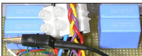
Figura 3.21. Conjunt de condensadors de 1000V per aconseguir una tensió estable i ràpida en la reproducció dels aguds.
