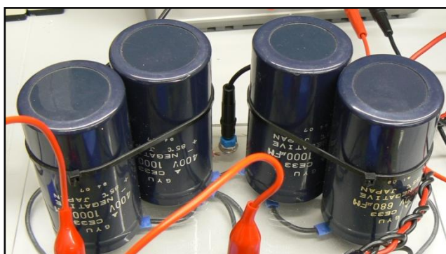
Figura 3.20. Conjunt de condensadors de 400V per aconseguir una tensió estable en la reproducció dels greus.
